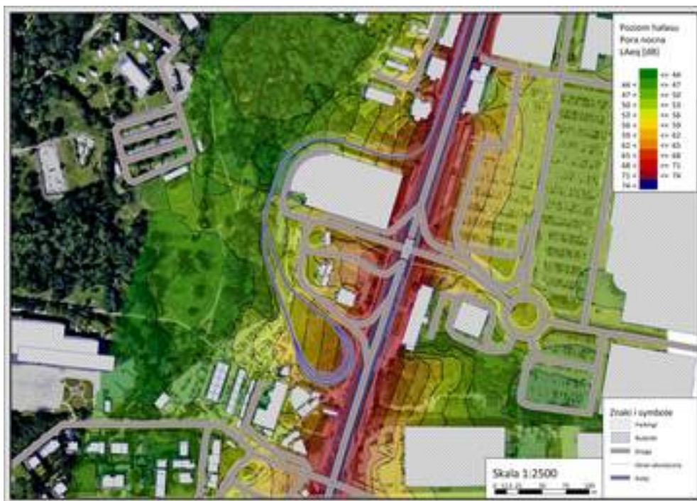
Rys. 3.12. Rozkład poziomy dźwięku A na wysokości 4 m n.p.t. w okolicy pętli tramwajowej Borek Fałęcki, pora nocna
