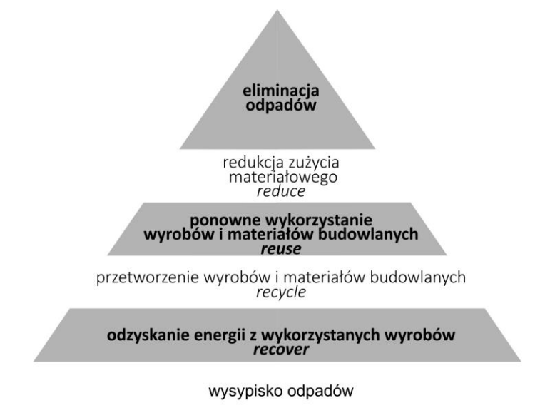
Rys. 2.1.4.1. Hierarchia jakościowa sposobów zagospodarowania odpadów ( waste hierarchy, waste pyramid ) od najbardziej negatywnie oddziałującego na środowisko naturalne do najmniej inwazyjnego i ekonomicznie uzasadnionego. Źródło: rysunek autorki.
