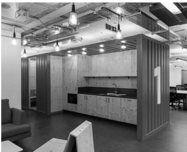
Fot. 7.4.1.2. Stalowe używane i odzyskane kontenery towarowe morskie zaadaptowane we wnętrzu biurowym jako struktury aneksu kuchennego. Google Campus, Londyn, Wielka Brytania, 2012, proj. Jump Studio. Źródło: http://www.dezeen.com/2012/05/01/google-campus-by-jump-studios [dostęp: 5.09.2014].
