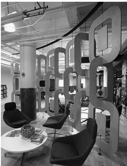
Fot. 7.1.1.1. Ażurowe podwieszane struktury ze sklejkę pełniące funkcję przegrody wizualnej i akustycznej umieszczonej w strefie ogólnodostępnej. Biuro LHB Inc., Minneapolis, USA, 2014, proj. LHB Inc., LEED-CI poziom Platinum, fot. B. Klotz. Źródło: http://finance-commerce.com/2014/08/top-projects-lhb-minneapolis-office [dostęp: 12.03.2015].
