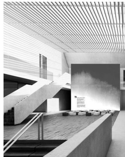
Rys. 4.3.2.1. Wewnętrzna wolnostojąca pełna struktura w foyer, jako egzemplifikacja części przegrody zewnętrznej pełniącej funkcję termicznego magazynu akumulacyjnego ( thermal storage ), poprzez termochromatyczną powłokę wykończeniową wskazuje zewnętrzną zmienną temperaturę modelu ilustrującą stopień nagromadzenia w nim energii cieplnej. Budynek 3E Politechniki Wrocławskiej, proj. P. Kuczia. Źródło: P. Kuczia.
